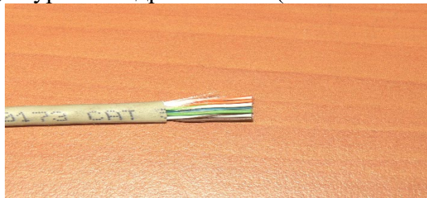
Рис. 4.8. Кабель «кручена пара» з підготовленими до монтажу в коннектор провідниками
