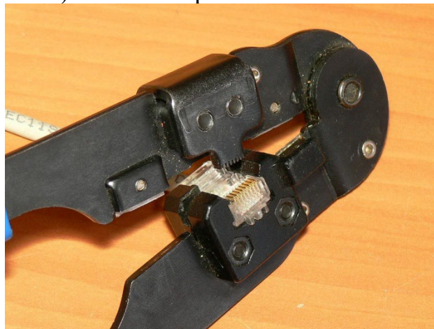
Рис. 4.9. Конектор RJ-45 в обтискному інструменті
