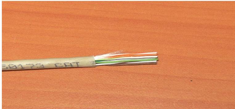
Рис. 4.7. Кабель «кручена пара» з розплетеними і випрямленими провідниками 5. Розташуйте провідники відповідно до обраного вами стандартом закладення (найбільш поширеним є стандарт 568В) і, зрізавши на їх кінцях шматочки по 2-4 міліметра, акуратно підрівняйте їх (як показано на рис. 4.8).
