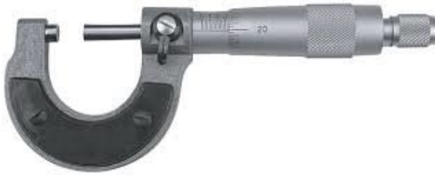
Мікрометр гладкий МК (ДЕРЖСТАНДАРТ 6507-78) Для точних зовнішніх вимірів
